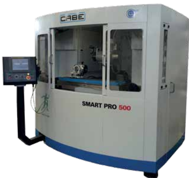
Affilatrice Smart Pro 500 equipaggiata con CNC e azionamenti Fanuc
